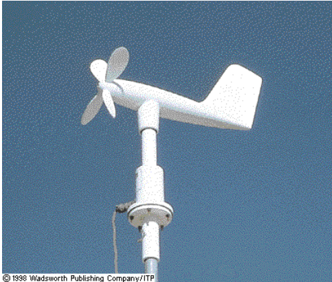
Fig. 1 Misura del vento.
