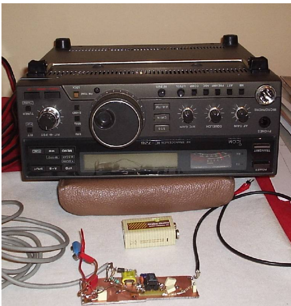
Illustration 6: Il 728 sottosopra, prima dell'installazione del convertitore.
