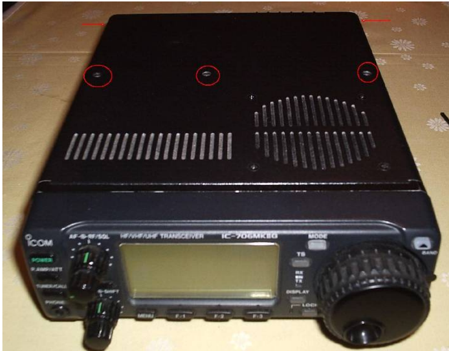
Illustration 2: Posizione delle cinque viti nel 706.
