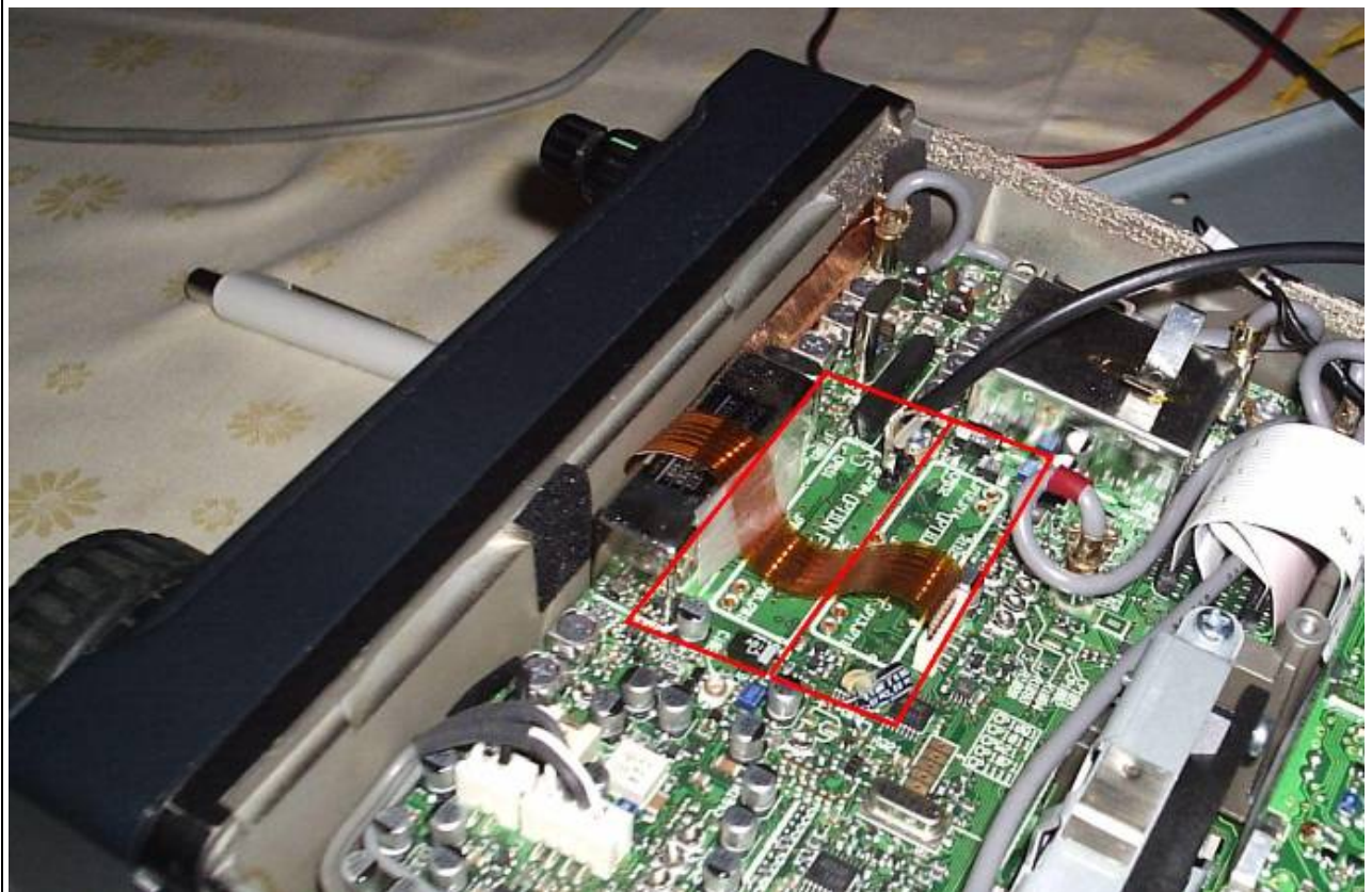
Illustration 5: Posizione dei filtri opzionali nel 706.
