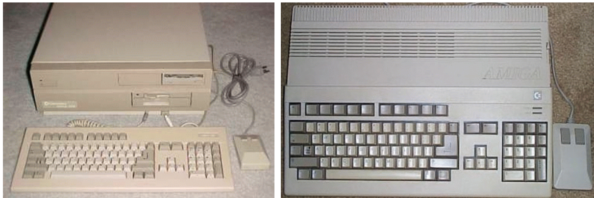
Un A2000 (a sinistra) ed un A500 (a destra). Notare il mouse a due pulsanti fornito di serie per entrambi i prodotti. Il tasto "Help", posto sopra il tasto cursore destro, non troverà un'applicazione nel sistema operativo fino all'introduzione, nel 1992, dell'AmigaGuide.
